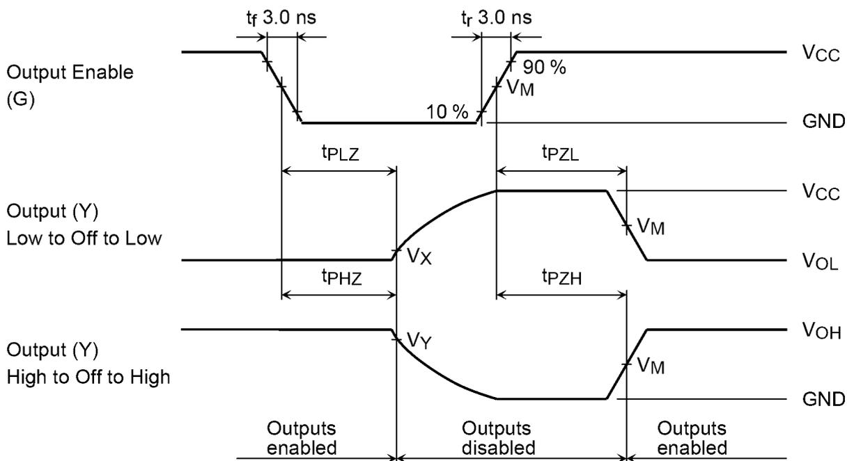
図 9.6.2  $t_{PLZ}$ ,  $t_{PHZ}$ ,  $t_{PZL}$ ,  $t_{PZH}$
