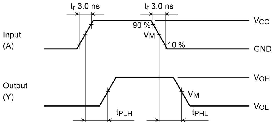
図 9.6.1  $t_{PLH}$ ,  $t_{PHL}$
