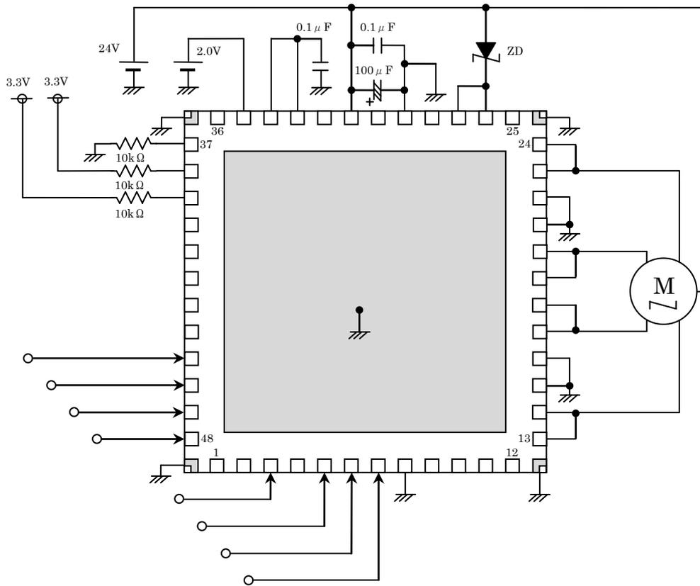
※ QFN パッケージのコーナーPAD および裏面放熱 PAD は必ず基板の GND に接続いただきますようお願いいたします。
