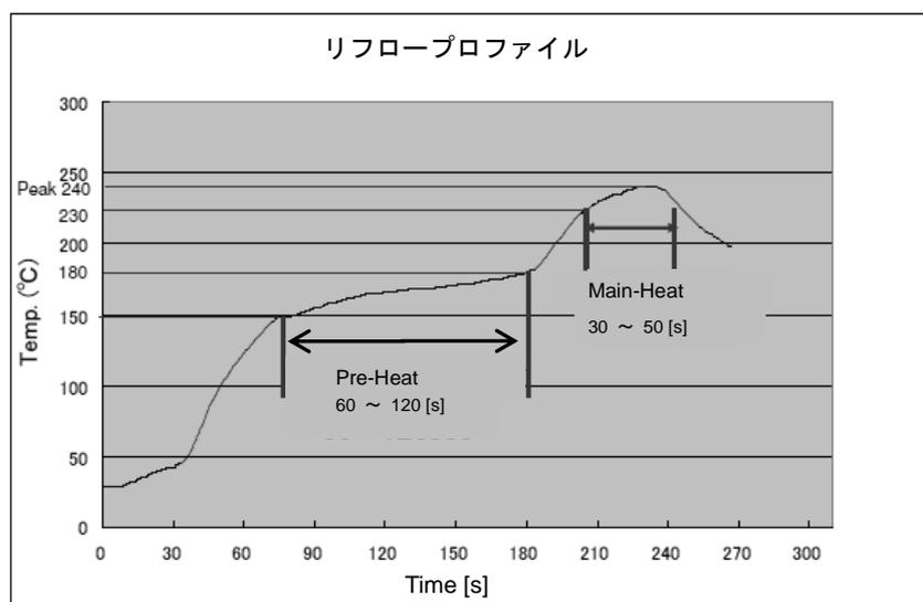
図 1. 推奨リフロープロファイル
